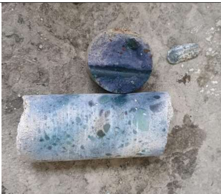
Fot. 3 Odwiert rdzeniowy stopniowa karbonatyzacja pH 8-10
